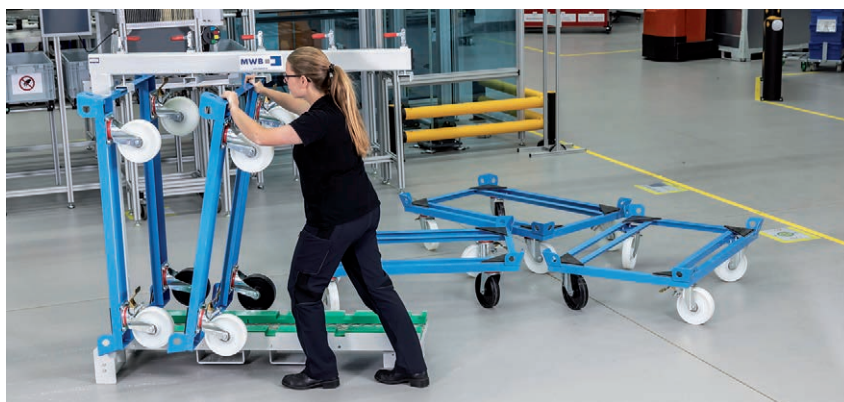
Das Trolleymagazin von MWB lässt sich von nur einer Person leicht und ergonomisch bedienen.
