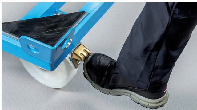
Bild 4: Die meisten Rolluntersetzer verfügen über solche Feststeller. In der Praxis werden sie selten benutzt – zu zeitaufwendig.
