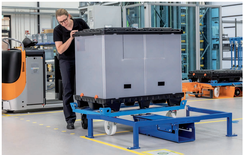
Bild 3: Handelsübliche Trolleys lassen sich leicht und schnell in die Dockingstation von MWB einschieben. Dort rasten sie automatisch und gut hörbar ein. Ideal auch an Produktions- und Montagelinien!
